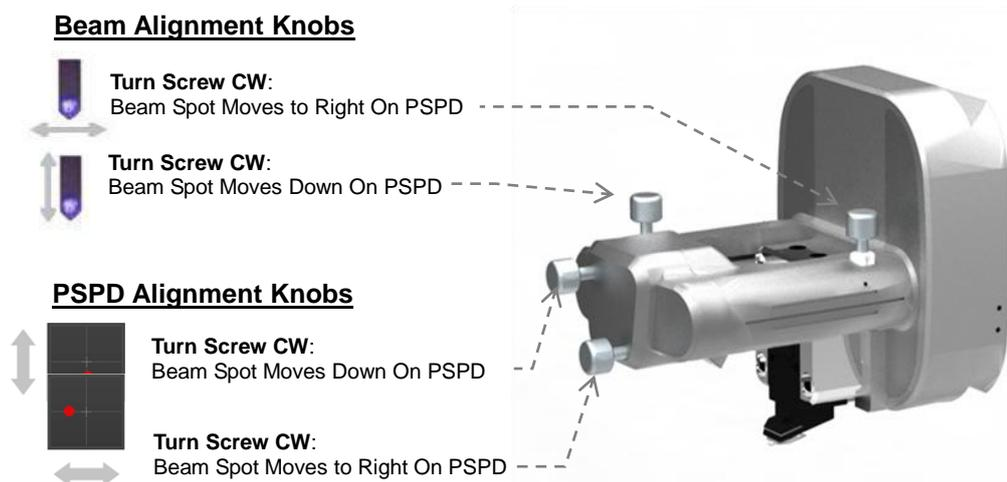
Figure 7-6. Beam & PSPD Alignment Knobs
