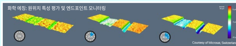
유리 보정 20× 대물렌즈를 사용한 20 µm 및 100 µm 트렌치의 전기화학 에칭 원위치 모니터링
